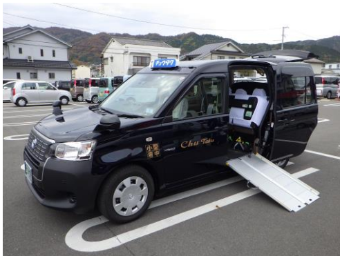
車両の横にスロープが装備されるタイプ
