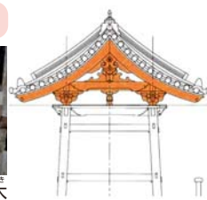
色塗り部分が 解体されました
