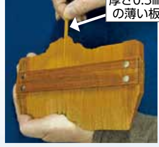
厚さ0.5mmの薄い板 厚さ0.5mmの薄い板が、くし状に約300枚並んでいる
